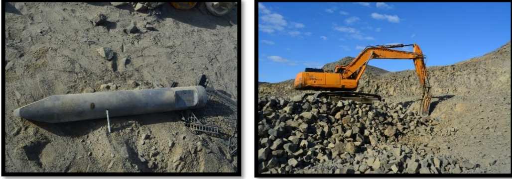
(صورة 123) تكسير أصلب مواقع البازلت بواسطة الجاكوش (صورة 124) الجاكوش الصلب المستخدم للتكسير
